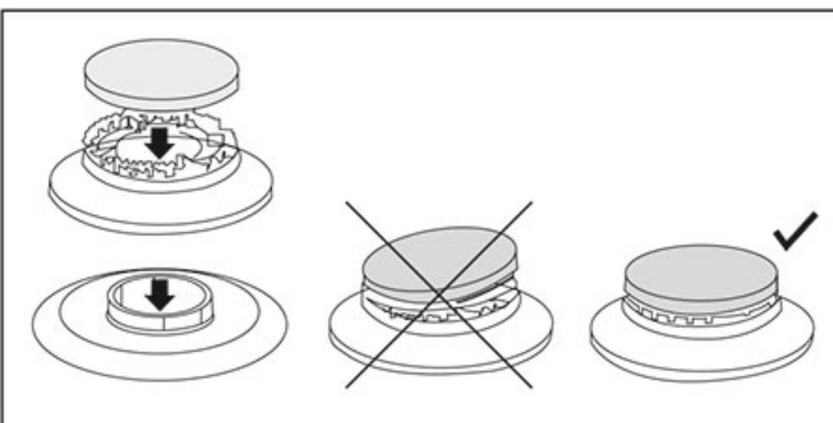
● برای خارج ساختن مواد خارجی احتمالی از داخل حفره های داخلی سرشعله ها ابتدا سرپوش آن را جدا کرده و دو قسمت تشکیل دهنده آن را (طبق شکل زیر) از هم جدا نمائید و پس از تمیز نمودن قطعات دو قطعه را در جای اولیه خود قرار داده و از صحت قرار گیری آنها مطمئن شوید.
