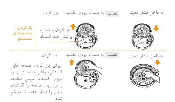
۱-پیش از استفاده،بررسی نمایید که آیا واشر و صفحه و پوشش ضد انسداد به صورت صحیح نصب شده باشد.
