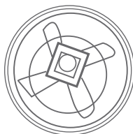
نصب غیر صحیح تیغه
